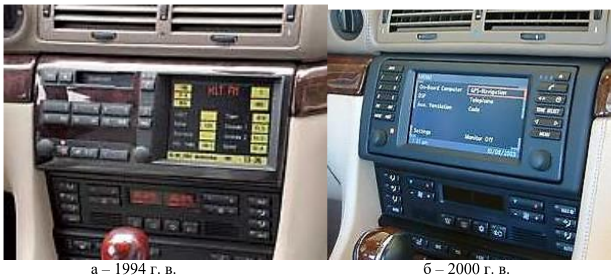
Рисунок 4 – Бортовой компьютер с функцией навигации автомобиля BMW 7-й серии e38 (а – 1994 г.в., б – 2000 г.в.)
