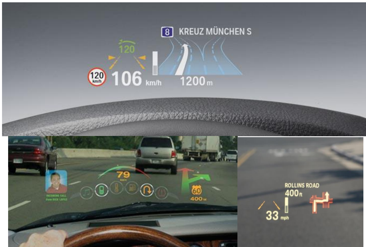
Рисунок 7 - Вид через лобовое стекло автомобиля с HeadUpDisplay автомобиля BMW (отображается: скорость движения, направление движения системы навигации, входящие звонки, воспроизводимый в данный момент времени музыкальный трек, индикатор запаса топлива и др.)
