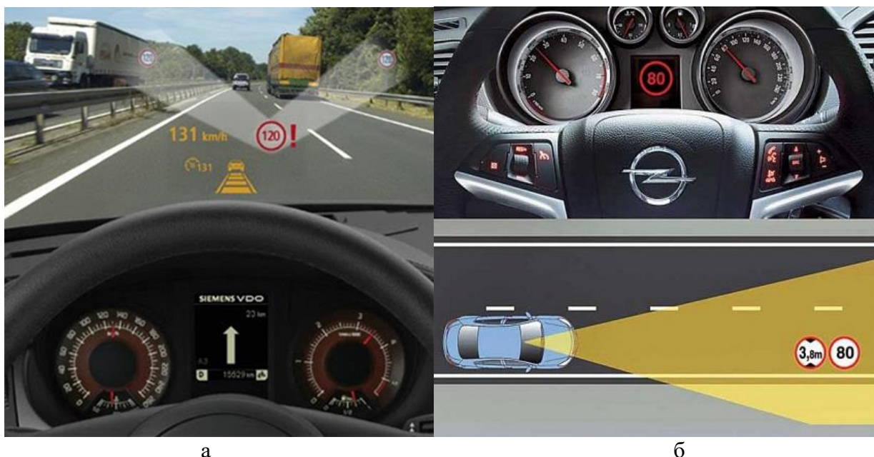
Рисунок 13 – Отображение считанной видеокамерой информации на: а – лобовое стекло; б – на панель приборов.
