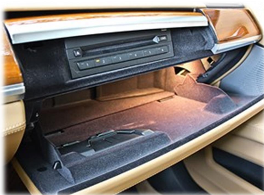
Рисунок 4 – Примеры установки чейнджера: а – в нише багажника автомобиля (BMW X5); б – в перчаточном ящике панели приборов (BMW 7 серии).
