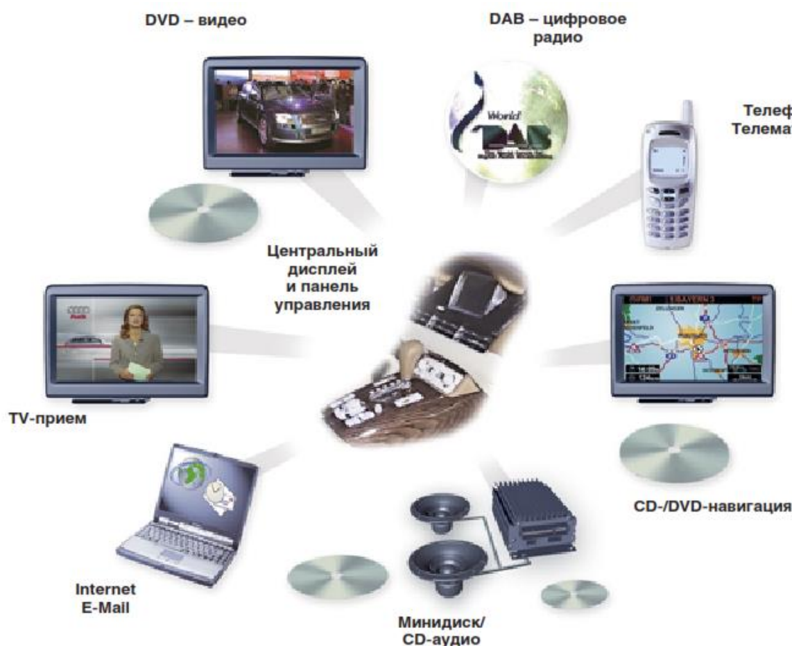
Рисунок 6 – Взаимодействие систем автомобиля по шине MOST.
