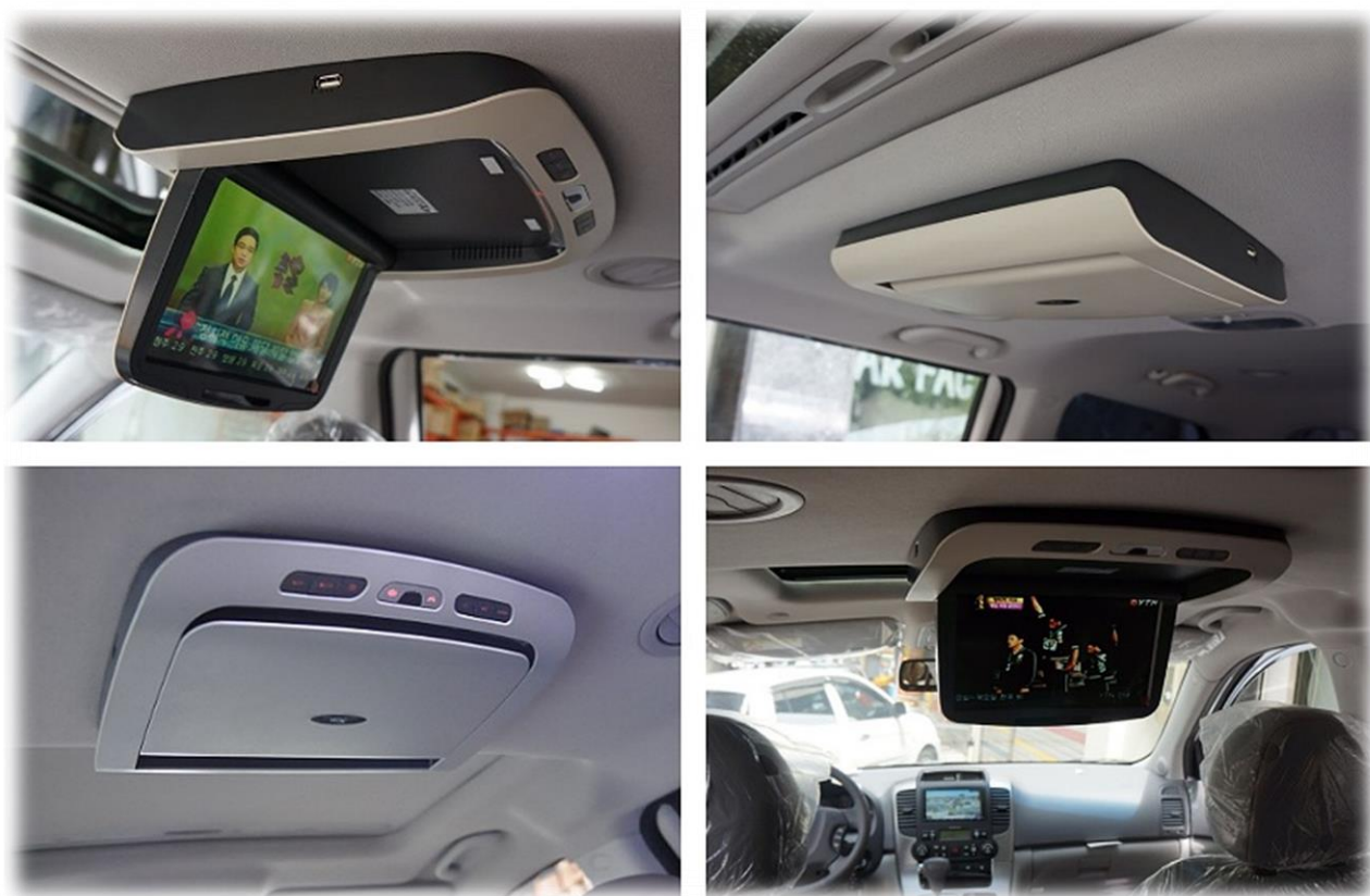
Рисунок 3 – Пример установки подвесных мониторов потолочного типа.
