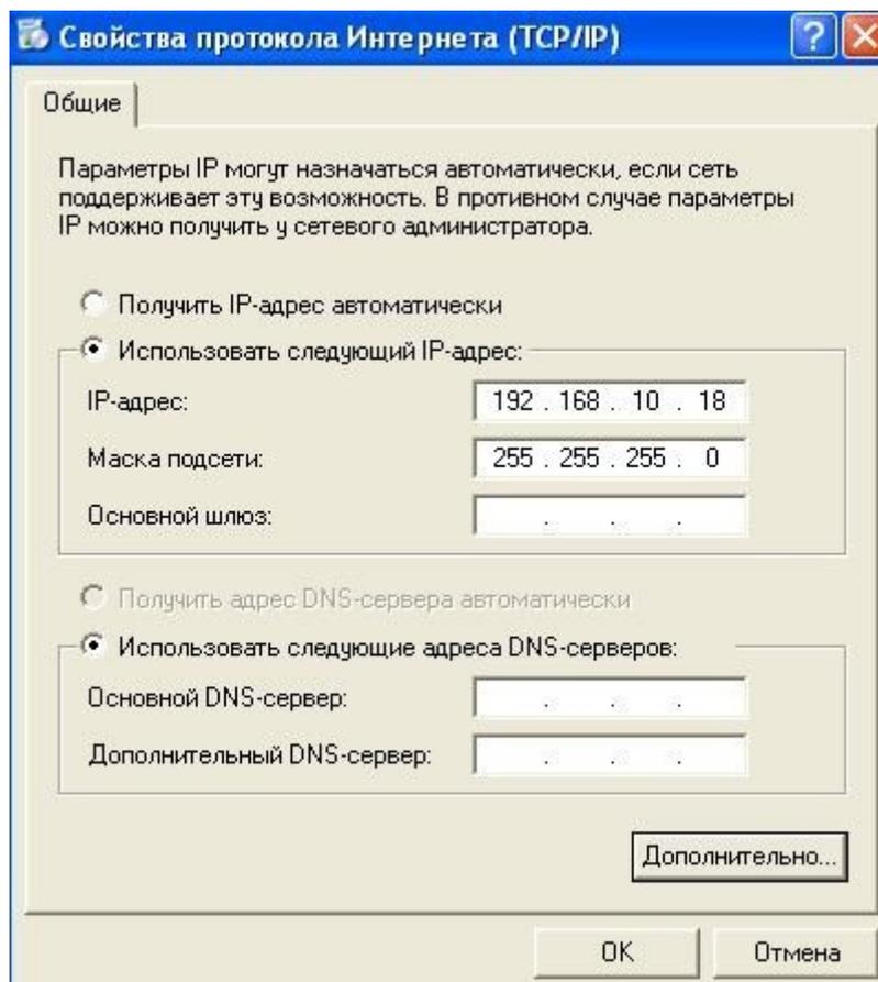
Рис. 2.2. Диалоговое окно «Свойства протокола Интернета (TCP/IP)»
