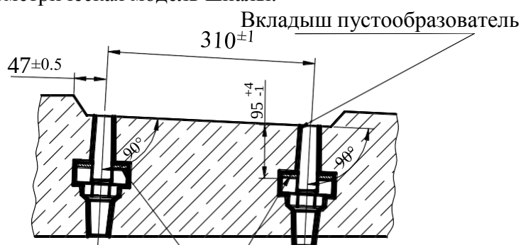
Рис. 7.3. Нормативная геометрическая модель подрельсовой части шпалы.
