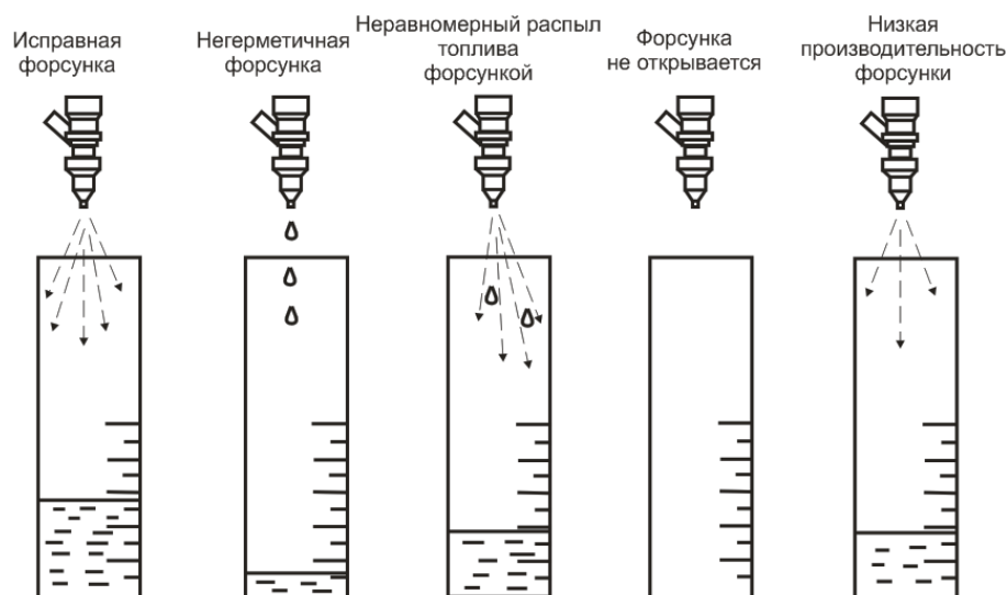
Рис. 27. Возможные варианты тестирования форсунок.
