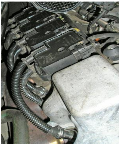
Рис. 17. Индивидуальное двойное дистанционное зажигание.
