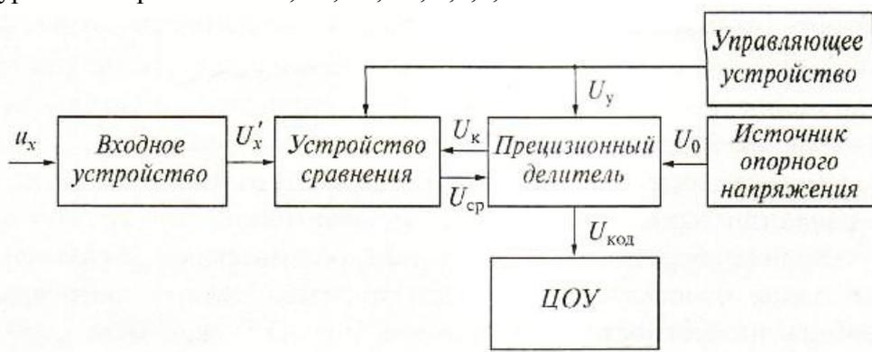
Рисунок 2. Структурная схема кодоимпульсного вольтметра
