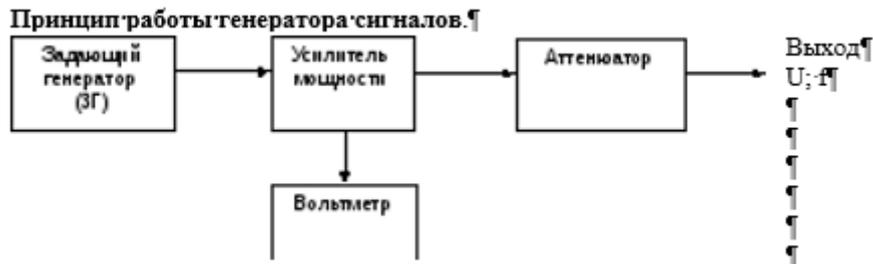
Рис. 3 Структурная схема генератора
