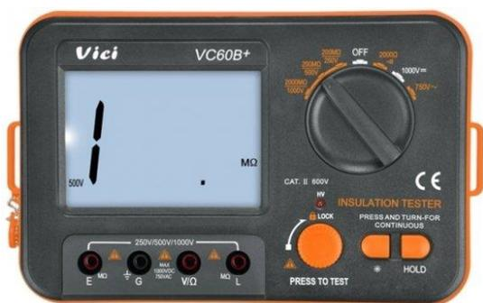
Это напряжение выбирается специальным переключателем или кнопками на панели прибора. Есть, безусловно, нормативы, согласно которым цепи разного рабочего напряжения проверяются соответствующим напряжением на щупах мегаомметра. Цифровые мегаомметры могут питаться от батареек, аккумуляторов, индивидуальных блоков питания.
