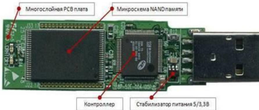
Рисунок 1 - Расположение основных элементов флэш-накопителя
