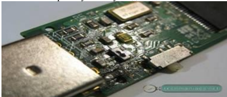
Рисунок 4 - Внешний вид флэш-накопителя со сгоревшим стабилизатором
