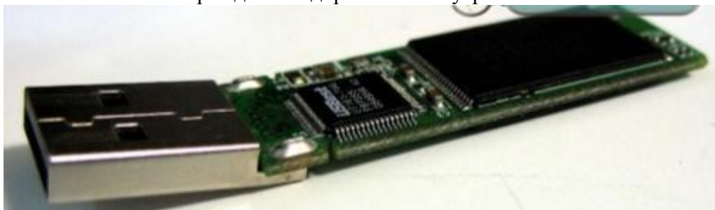
Рисунок 3 - Внешний вид флэш-накопителя со сломанным разъемом
