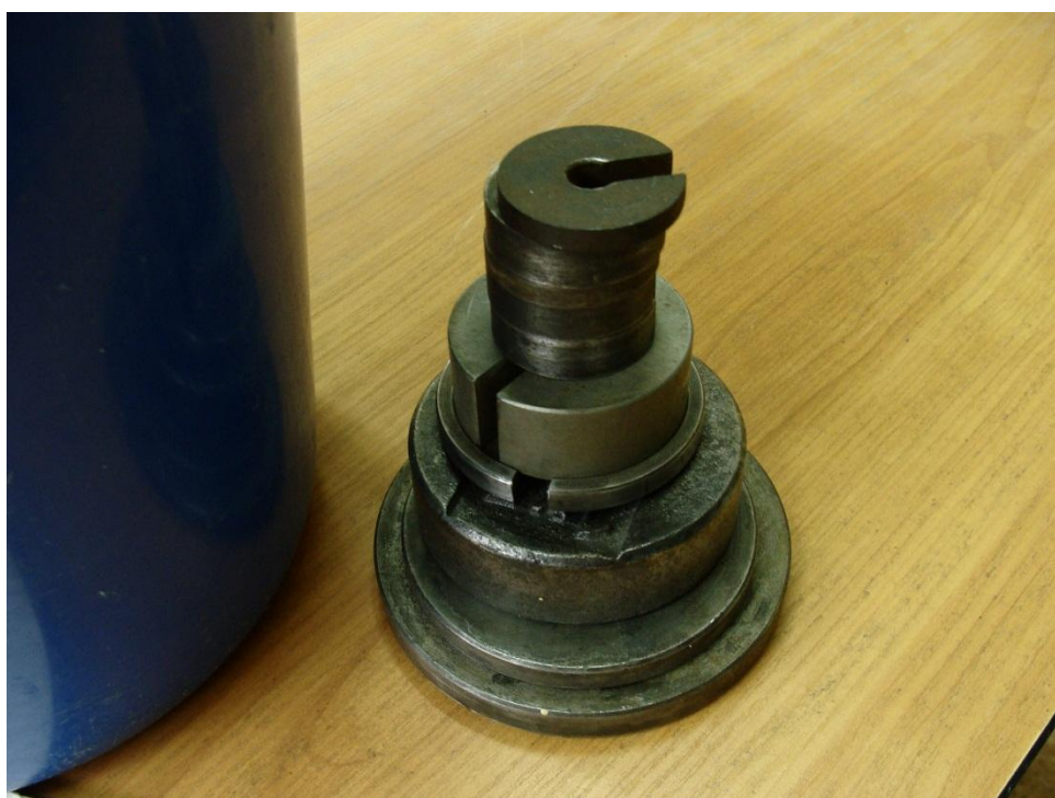
Рис. 5.6.4. Комплект разновесов для выполнения лабораторной работы
