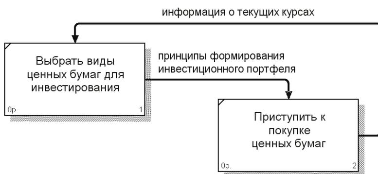
Рисунок 1.7 – Комбинированная стрелка *выход – обратная связь на управление*
