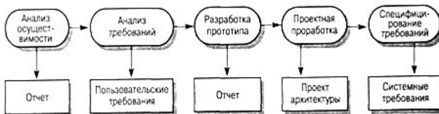
Рисунок 3.1 Этапы процесса разработки спецификации
