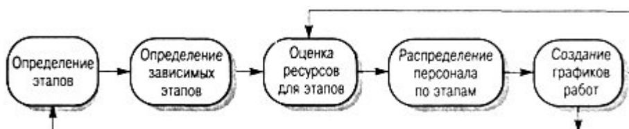
Рисунок 3.2 Процесс составления графика работ
