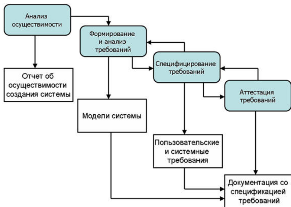
Рисунок 1.1 Процесс разработки требований
