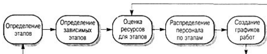
Рисунок 4.2 Процесс составления графика работ
