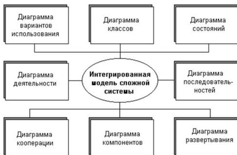
Рисунок 2.1 Интегрированная модель сложной системы в нотации языка UML
