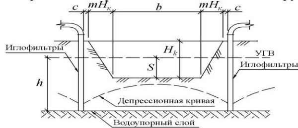
Рис. 6. Схема для расчета иглофильтровой установки
