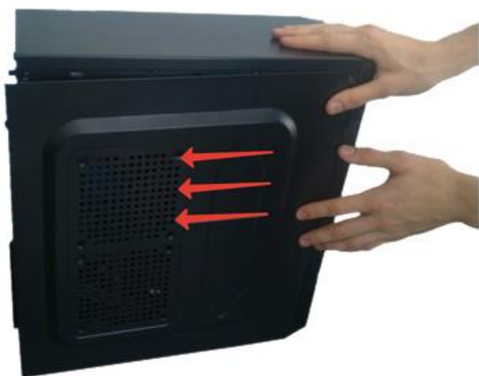
Снимаем крышку системного блока компьютера
