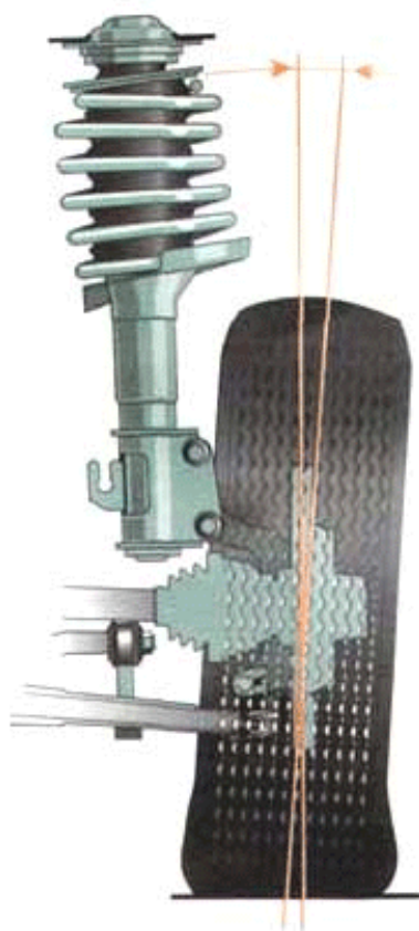
Рис. 2. Угол развала колеса.
