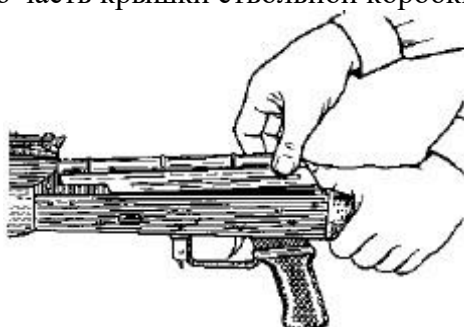
Рис. 13. Отделение крышки ствольной коробки
