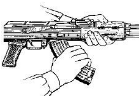
Рис. 19. Присоединение газовой трубки
