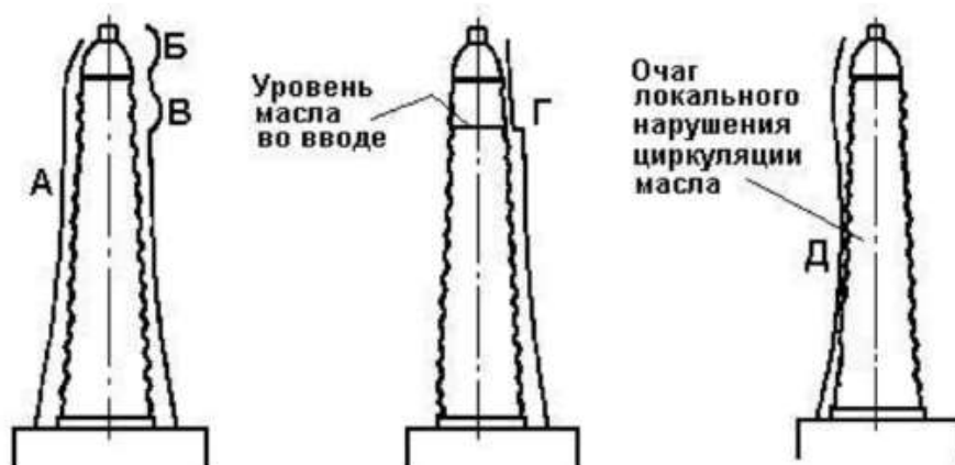
Рисунок 3 - Характер распределения температуры по высоте маслонаполненного ввода.
