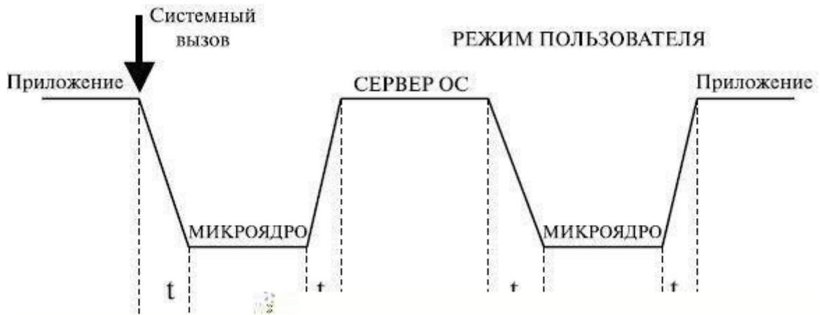
**Рис. 3.10.** Выполнение системного вызова в операционной системе с микроядром
