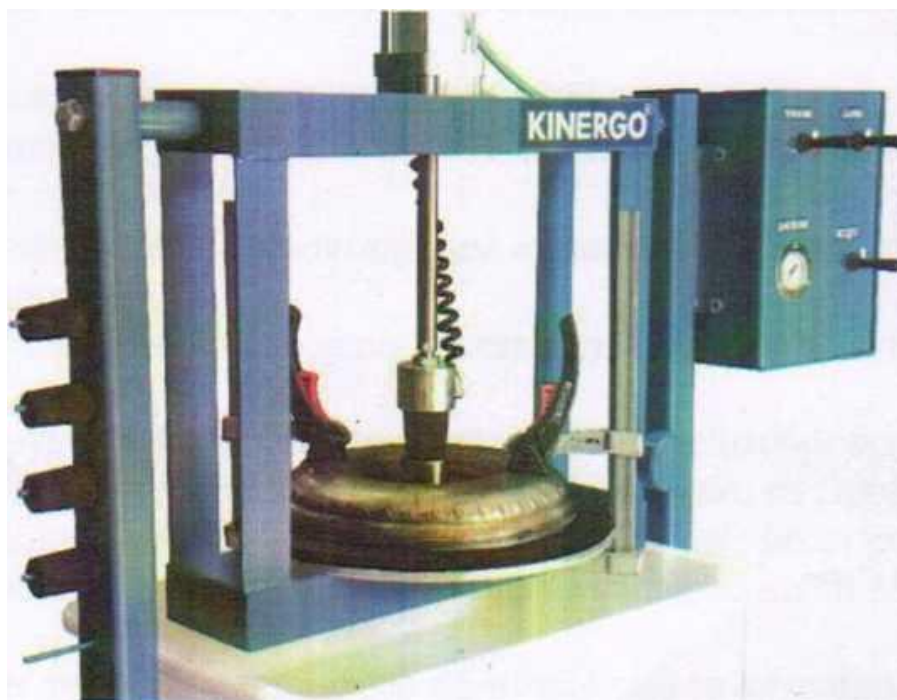
Рисунок 5 – Проверка герметичности соединения гидротрансформатора
