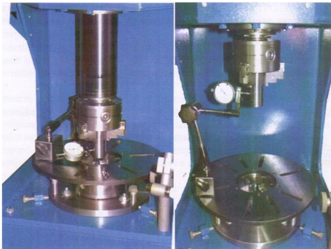
Рисунок 16 - Нижнее и верхнее положение патрона - измерение биения при настройке станка
