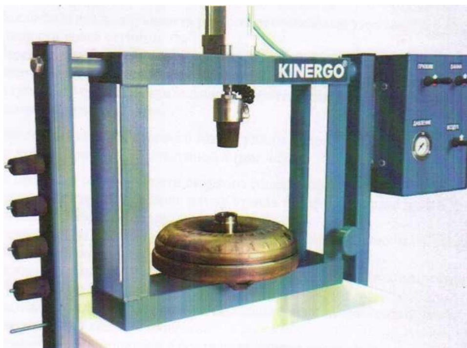
Рисунок 3 - Установка гидротрансформатора на основание.
