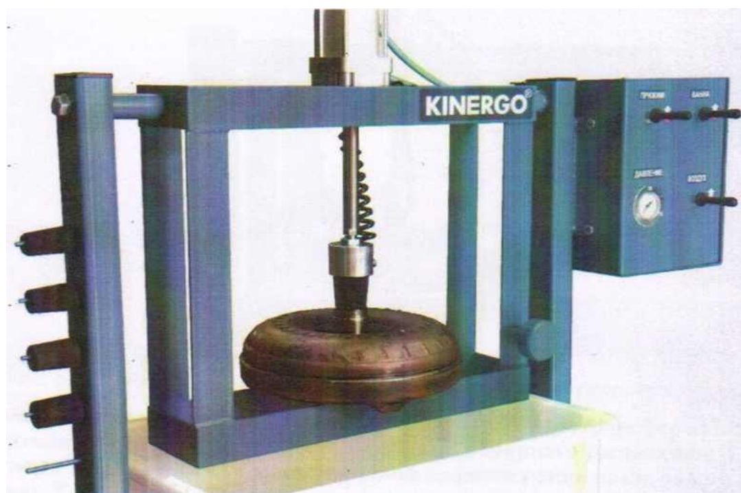
Рисунок 4 - Прижим патрона к гидротрансформатору
