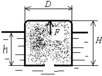
5. Опрокинутый танк с нефтью плавает в воде. Диаметр танка  $D = 5$  м, высота  $H = 4$  м, вес 4000 кГ. Плотность нефти  $\rho_n = 850$  кг/м<sup>3</sup>. Определить глубину его погружения  $h$  и силу  $F$  давления нефти на дно танка.
