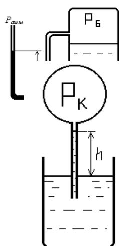
1. Определить давление  $P_B$  в баке, наполненном газом и жидкостью, если разность уровня ртути в манометре  $h = 0.3$  м. Плотность ртути  $\rho_{Hg} = 13.6 \text{ г/см}^3$ .
