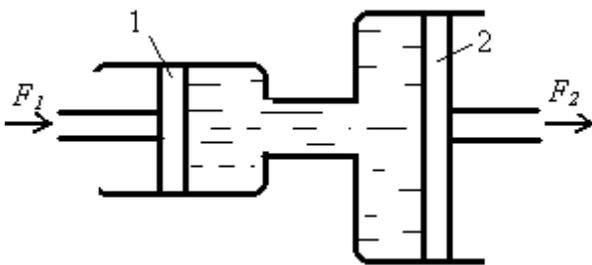
3. Гидроусилитель состоит из двух цилиндров 1 и 2, соединенных трубкой. Площадь поршня  $S_1 = 2 \text{ см}^2$ . На него действует сила  $F_1 = 50 \text{ кГ}$ . Площадь поршня  $S_2 = 20 \text{ см}^2$ . Определить силу  $F_2$  на втором гидроцилиндре и перемещение поршня, если первый поршень переместился на
