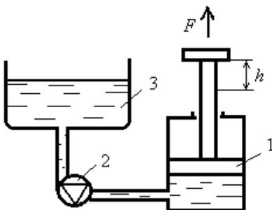
–Гидравлический подъемник развивает силу  $F = 2000 \text{ кГ}$ . Площадь поршня – 1 гидроцилиндра  $S = 40 \text{ см}^2$ . Какое давление должен обеспечить насос – 2, чтобы развить эту силу? Какова должна быть вместимость бака – 3, чтобы обеспечить подъем груза на высоту  $h = 1 \text{ м}$ ?
