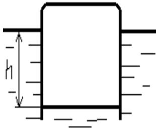
2. Полый тонкостенный цилиндр опустили в воду вверх дном. Цилиндр плавает так, что уровень воды внутри цилиндра находится на глубине  $h = 20 \text{ см}$  от поверхности окружающей воды. Плотность воды  $1000 \text{ кг/м}^3$ , вес цилиндра  $2 \text{ кГ}$  ( $20 \text{ Н}$ ). Определить площадь доньшка цилиндра.
