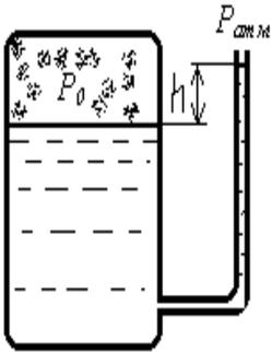
1. В закрытом сосуде находится газ и жидкость с плотностью  $\rho_{Hg} = 13.6 \text{ г/см}^3$ . С сосудом соединена пьезометрическая трубка. Определить давление газа в сосуде  $P_0$ , если жидкость в трубке
