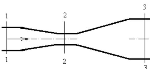
По горизонтальному трубопроводу переменного сечения течет жидкость. Расход равен 15 л/с. Плотность жидкости 780 кг/м<sup>3</sup>. Диаметры трубопровода в характерных сечениях  $d_1 = 50$  мм,
