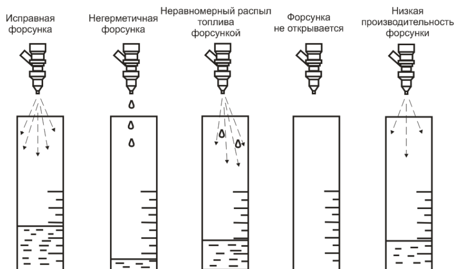
Рис. 27. Возможные варианты тестирования форсунок.
