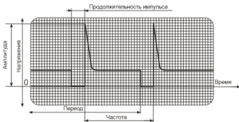
Рис. 21. «Образцовая» осциллограмма работы форсунки
