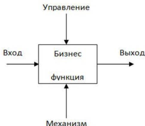
Рисунок 2.1 - Функциональный блок
