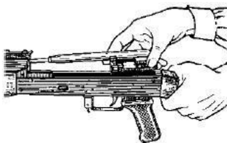
Рис. 15. Отделение затворной рамы с затвором
