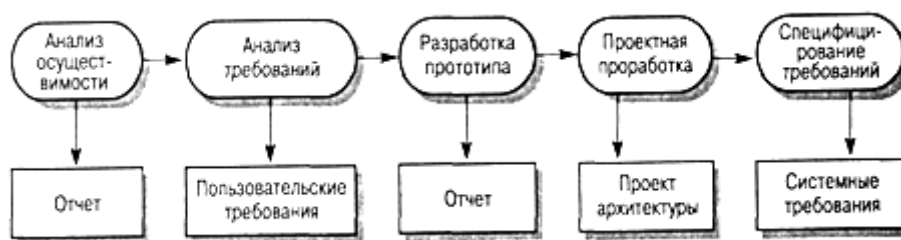
Рисунок 4.1 - Этапы процесса разработки спецификации
