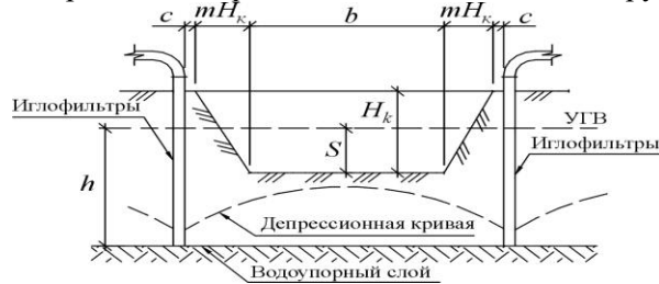
Рис. 6. Схема для расчета иглофильтровой установки
