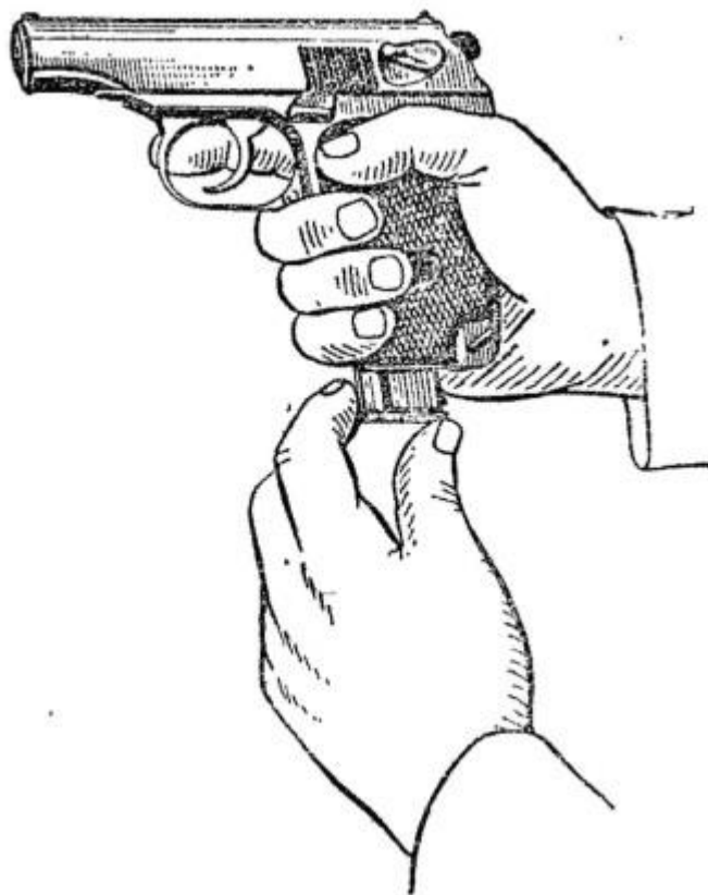
Рис. 8. Вставление магазина в основание рукоятки
