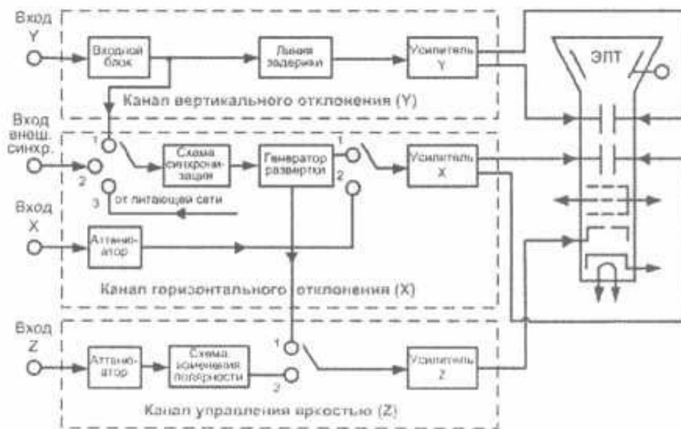
Рис. 4.1. Обобщенная структурная схема универсального ЭЛО на основе ЭЛТ
