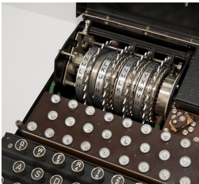
а) четыре последовательно соединённых ротора
