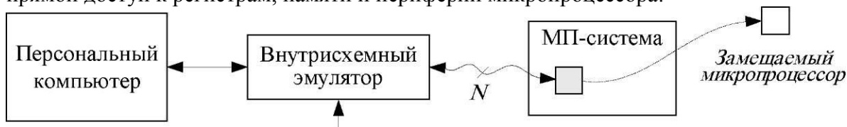
Рис. 33.2. Отладка с помощью внутрисхемного эмулятора N - количество выводов процессора
