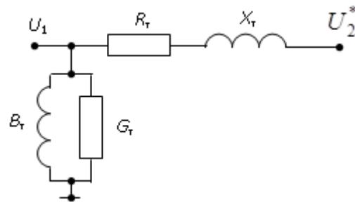
Рисунок 1.2 – Г-образная схема замещения двухобмоточного трансформатора
