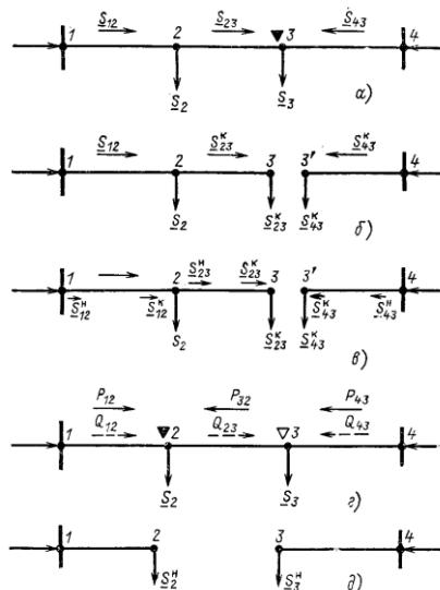
Рисунок 12.1 – Распределение потоков мощности в замкнутой сети
