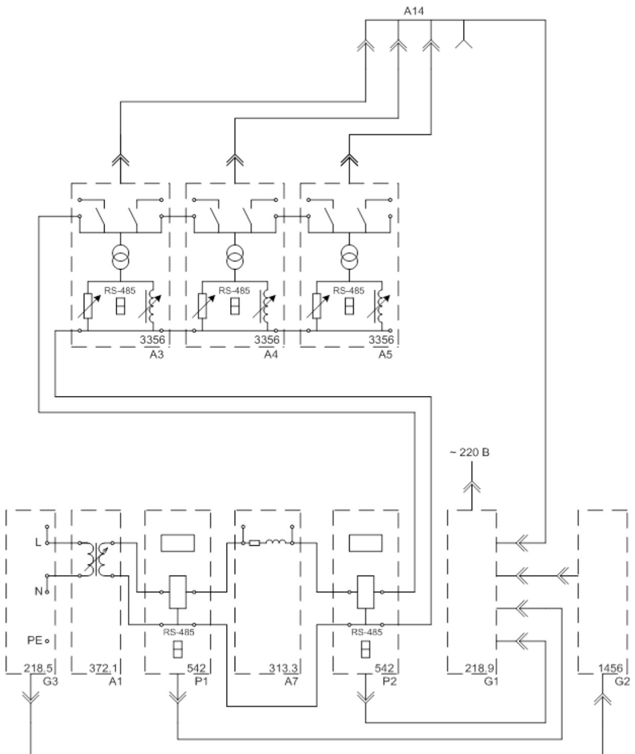
Рисунок 1.4 – Схема для измерения параметров установившегося режима работы фазы линии электропередачи.
