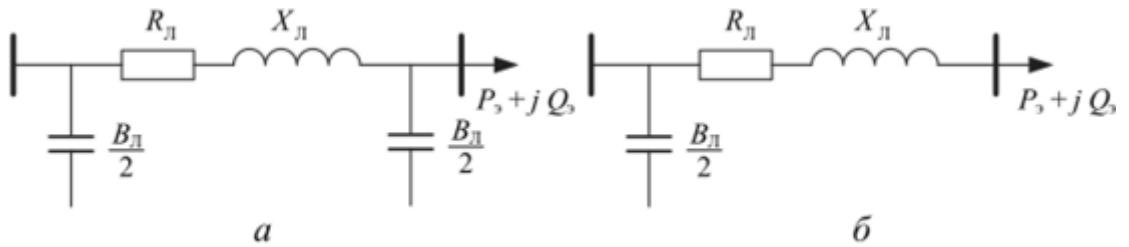
Рисунок 1.2 – Эквивалентные схемы замещения для электрической сети
