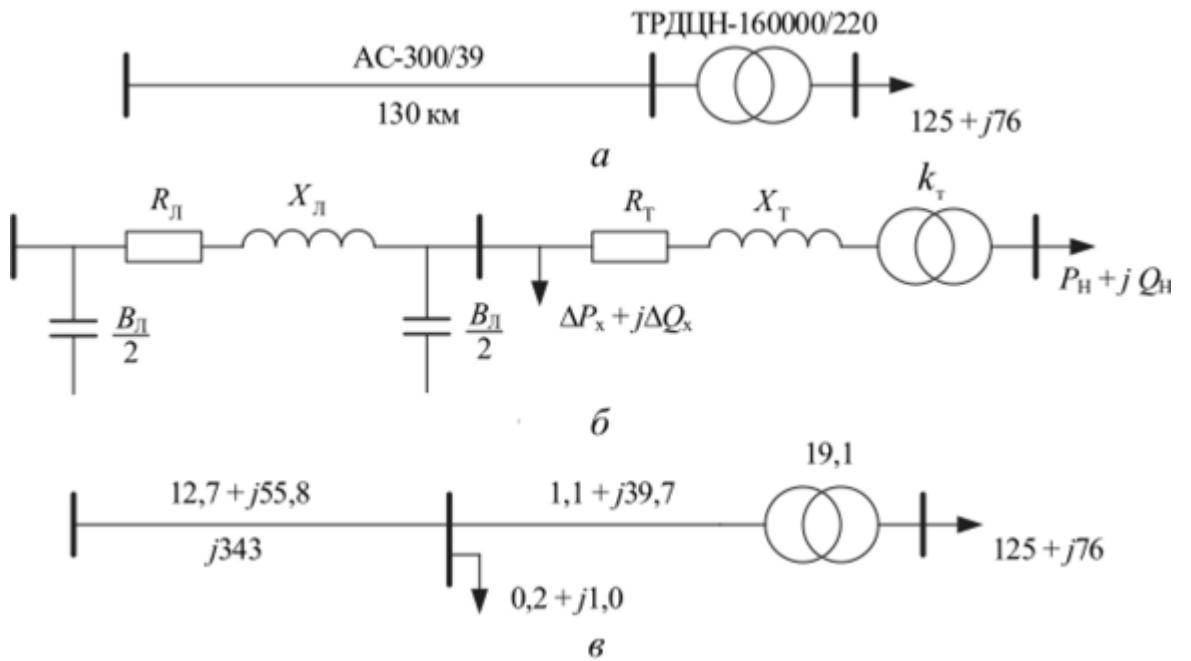
Рисунок 1.1 – Схема замещения
