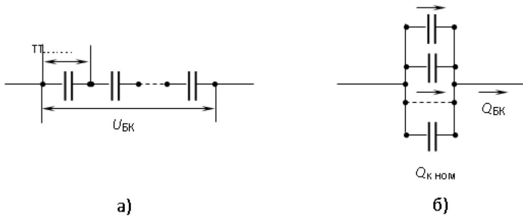
Рисунок 15.3 – Соединение конденсаторов
