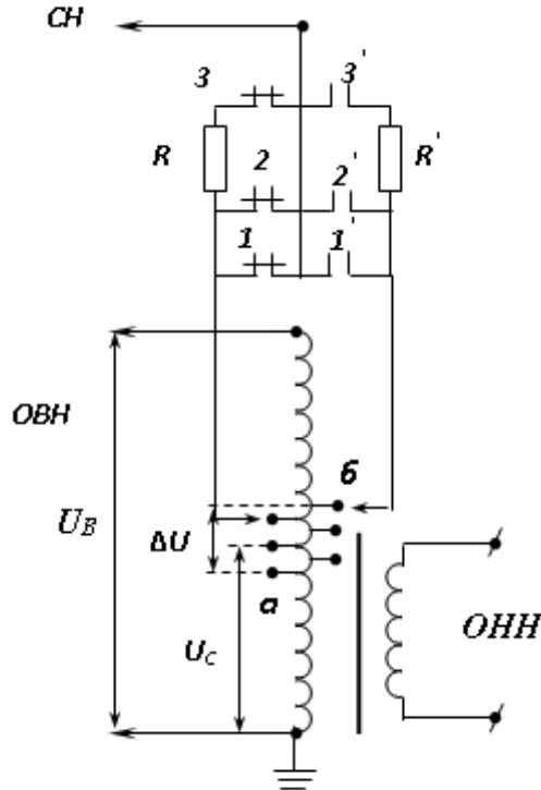
Рисунок 7.2 – Схема РПН на активных сопротивлениях
