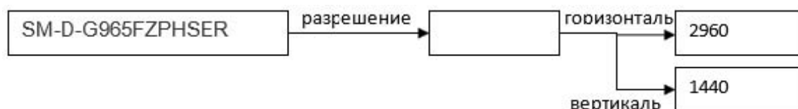
Рис. 1 Граф, описывающий разрешение дисплея
