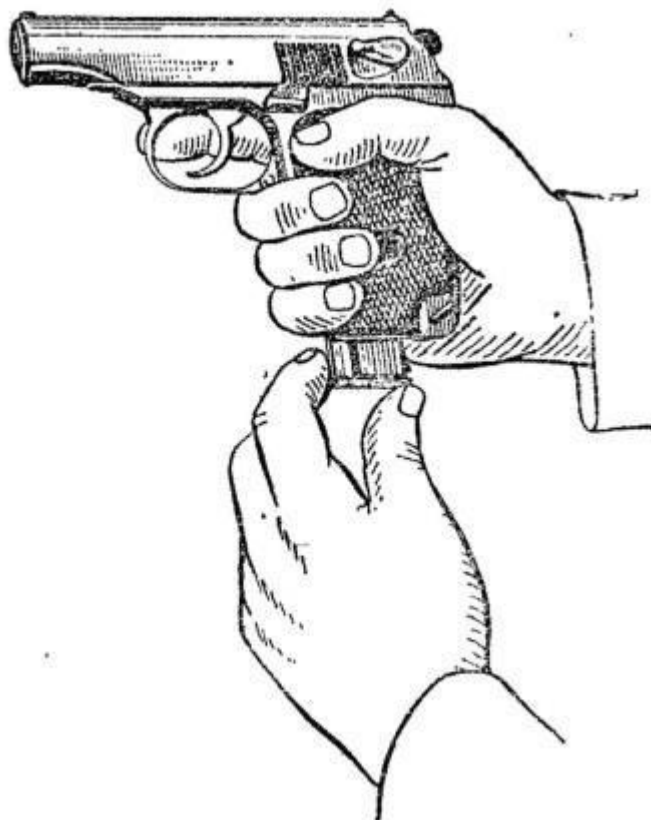
Рис. 8. Вставление магазина в основание рукоятки
