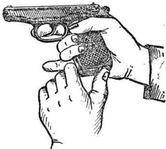
Рис. 3. Извлечение магазина из основания рукоятки
