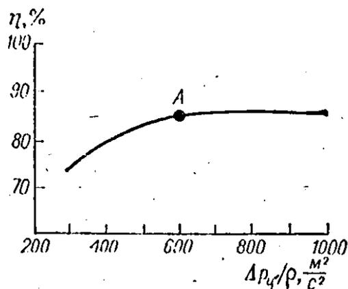
Рис. 3. Зависимость степени очистки п циклона от соотношения  $\Delta p_{ц}/\rho$
