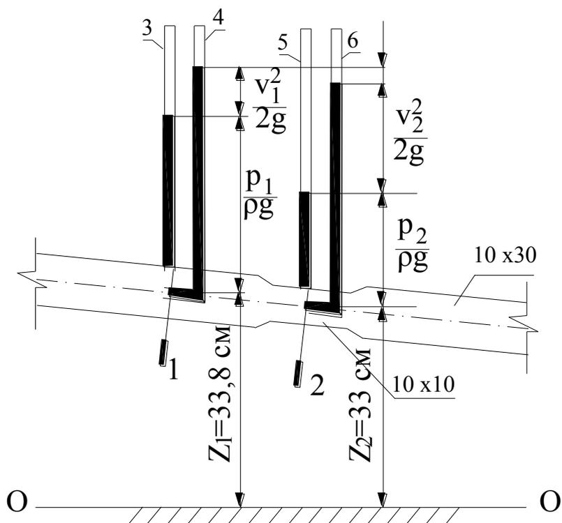
Рисунок 3.1 Расчетная схема трубчатого расходомер (расходомера Вентури)
