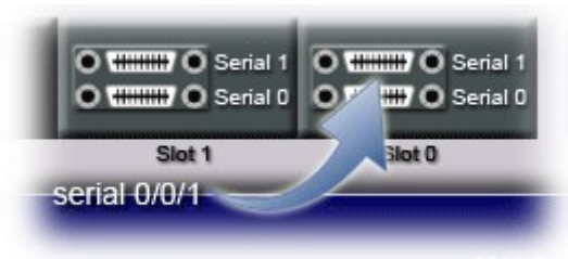
Рис. 14. Выбор интерфейса serial 0/0/1 на маршрутизаторе 2811 Router B
