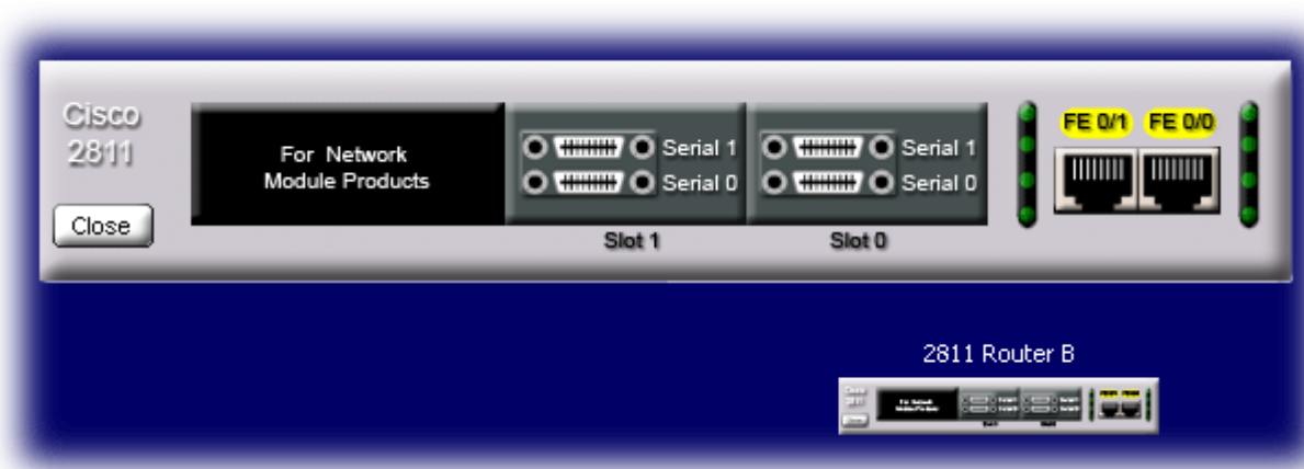
Рис. 12. Графический интерфейс маршрутизатора 2811 Router A
