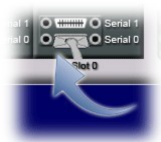
Рис. 20. Выбор последовательного интерфейса serial 0/0/0
