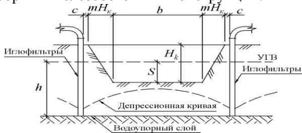
Рис. 6. Схема для расчета иглофильтровой установки
