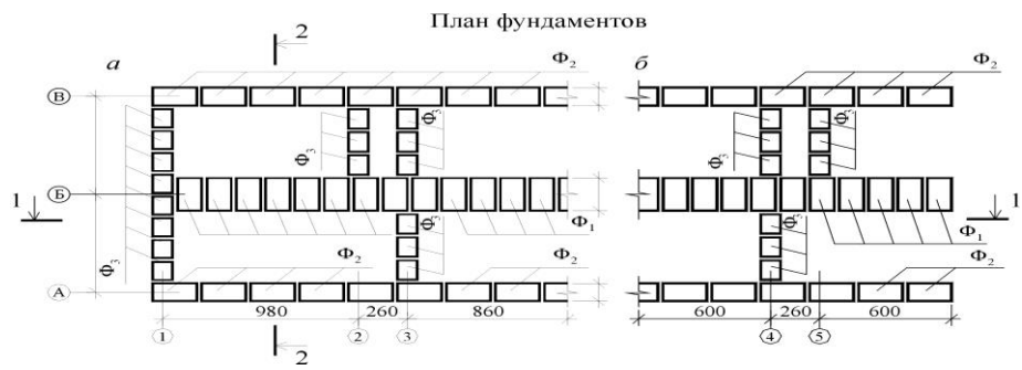
Рис. 1. Планы фундаментов и раскладки плит перекрытия над подвалом: a – для торцевой блок-секции; б – для рядовой блок-секции
