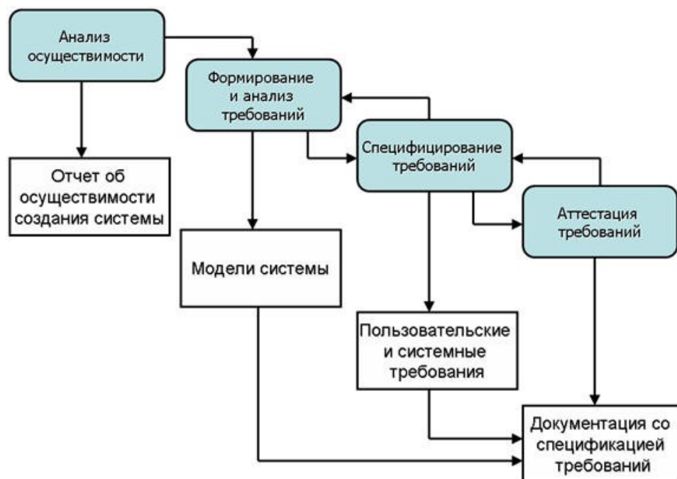
Рисунок 1.1 - Процесс разработки требований
