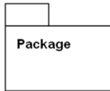
Рисунок 3.16 - Обозначение пакета в UML
