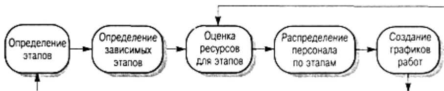
Рисунок 3.2 - Процесс составления графика работ
