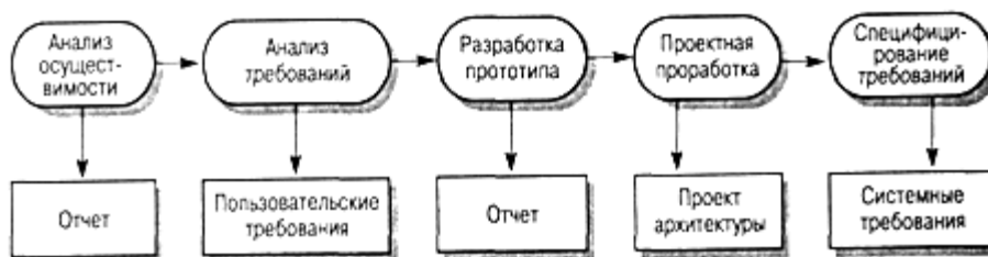
Рисунок 3.1 - Этапы процесса разработки спецификации
