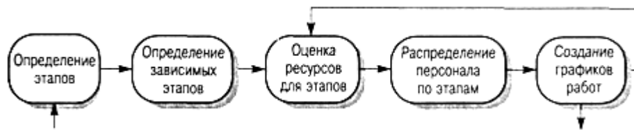
Рисунок 4.2 - Процесс составления графика работ
