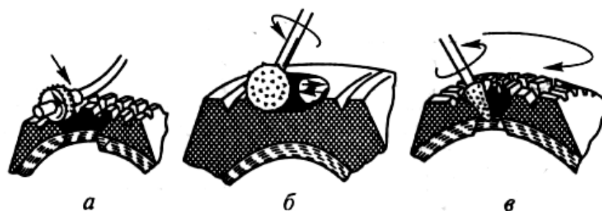
Рис. 5.2. Способы шероховки поврежденных мест покрышки:
