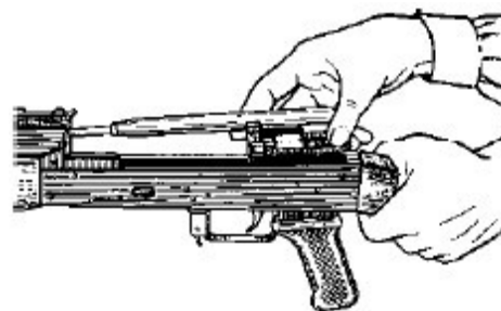
Рис. 15. Отделение затворной рамы с затвором
