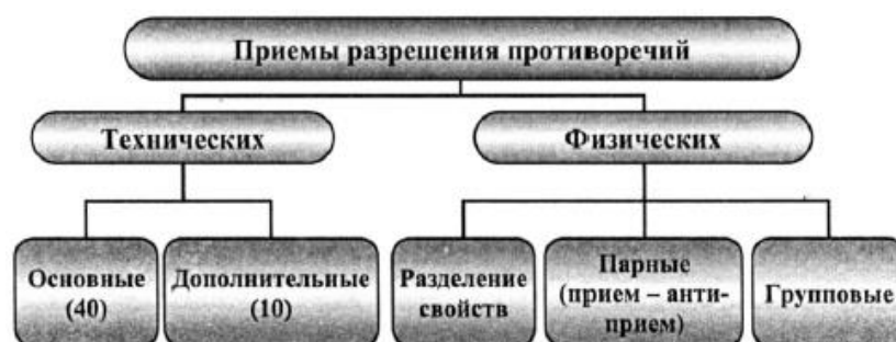
Рис. 1. Схема приемов разрешения противоречий
