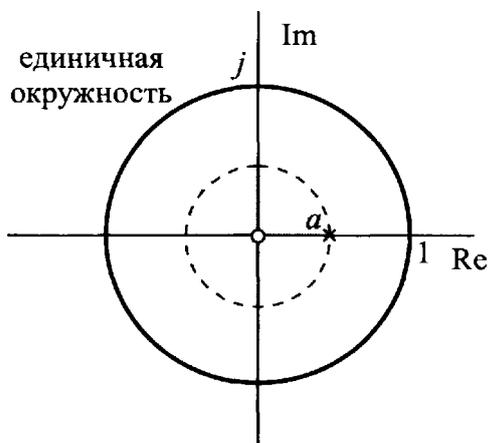
Рисунок 4. Схема нулей и полюсов в ОС.
