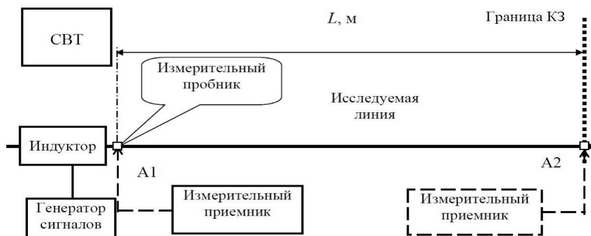
Рисунок 1 - Схема измерения реального затухания в линии
