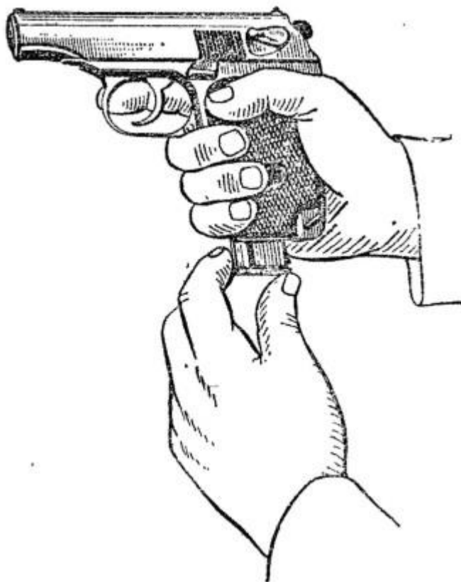
Рис. 8. Вставление магазина в основание рукоятки
