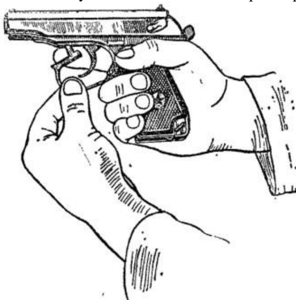
Рис. 4. Оттягивание спусковой скобы
