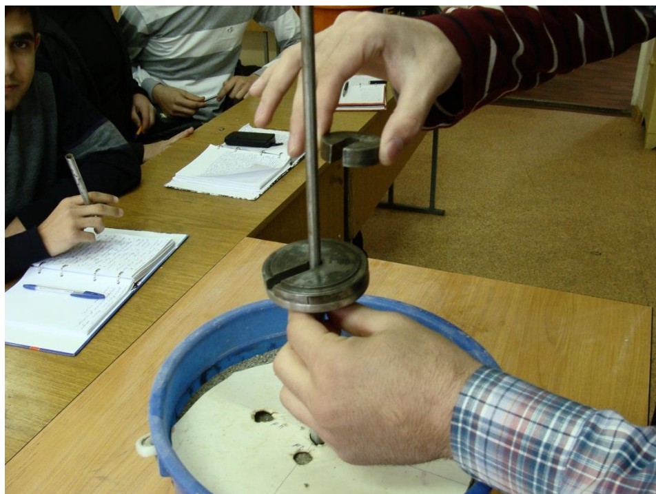
Рис. 5.6.5. Установка сваи в отверстие шаблона, в целях погружения сваи
