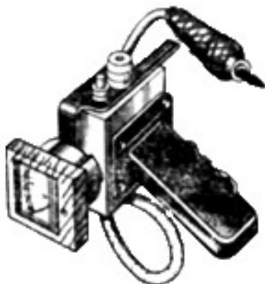
Рисунок 7.5. Пробник аккумуляторный мод. Э107
