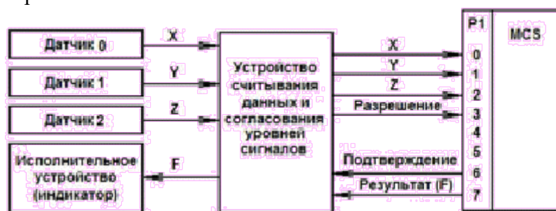
Рис. 26.1. Структурная схема микропроцессорной системы обработки битовой информации
