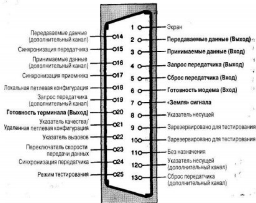
Рисунок 3.- Назначение контактов Сом порта.
