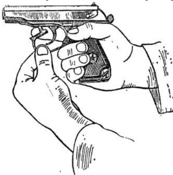
Рис. 4. Оттягивание спусковой скобы
