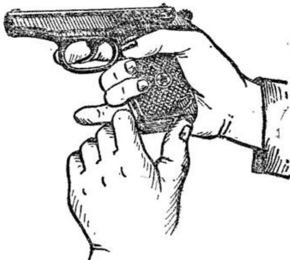
Рис. 3. Извлечение магазина из основания рукоятки
