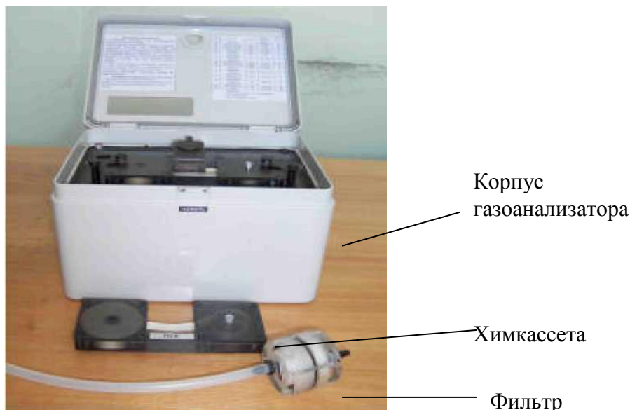
Рисунок 3.2 – Общий вид газоанализатора ГАНК-4
