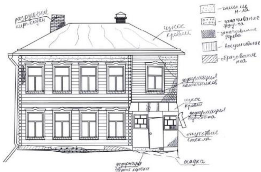
Рисунок 3 – Дефектная карта фасада
