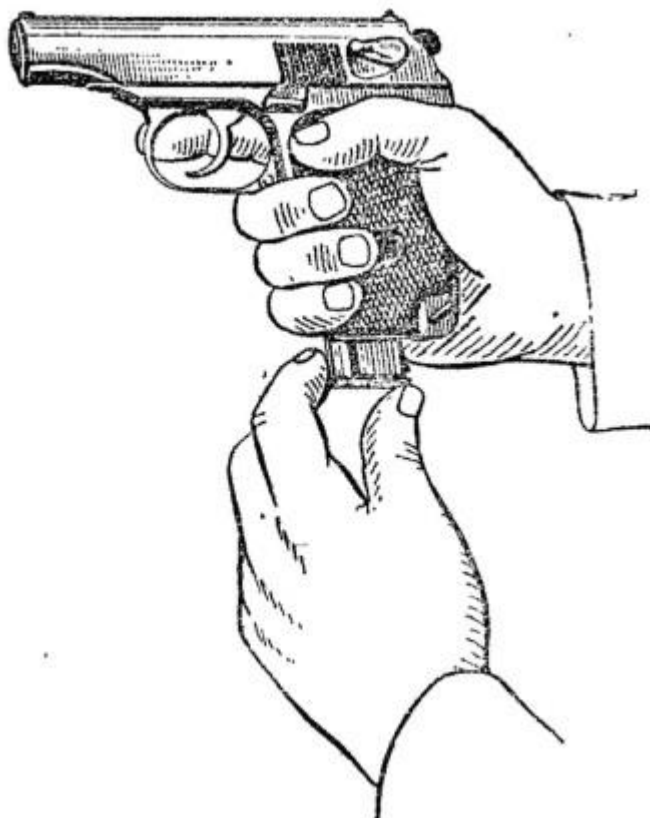
Рис. 8. Вставление магазина в основание рукоятки
