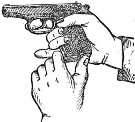
Рис. 3. Извлечение магазина из основания рукоятки
