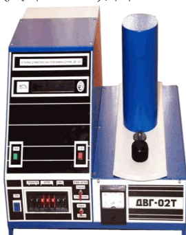
Комплект индивидуальных дозиметров типа ИД-02 (ДДНТ-02), ДВГ-02Т
