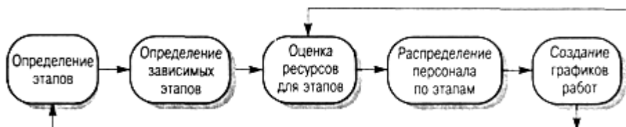
Рисунок 4.2 - Процесс составления графика работ
